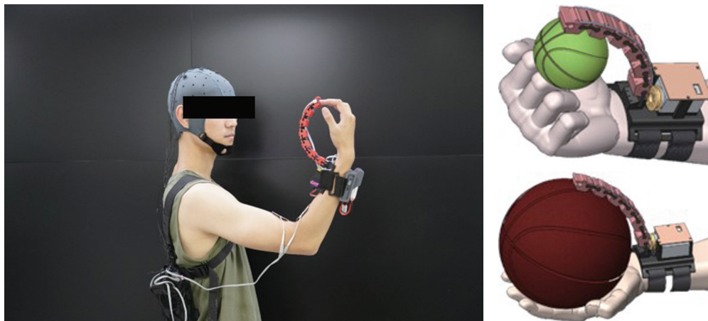
图2 脑控外肢体手指机器人系统(左图为外肢体手指系统的穿戴实物图,右图为外肢体手指配合人手实现抓握功能的三维示意图) [39]
