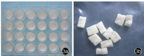
图3 壳聚糖多孔支架的大体形状 3a 修剪成圆形 3b 修剪成小块状
